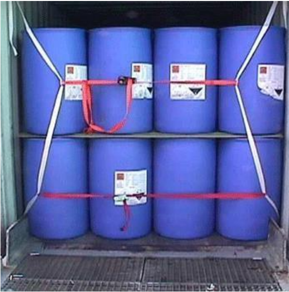
Hình 2-2: Vận chuyển chất lỏng được đóng vào thùng và được cố định bằng dây với thùng xe
